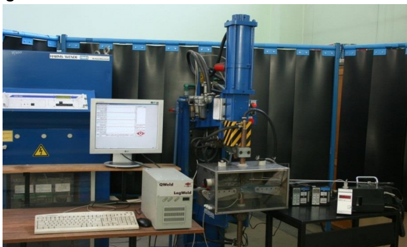
Fot.1. Stanowisko doświadczalne do badania emisji pyłu i gazów przy zgrzewaniu rezystancyjnym punktowym
