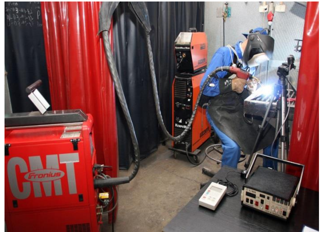
Fot.4. Stanowisko szkoleniowe spawaczy, spawanie metodą Cold Metal Transfer; badania w środowisku pracy
