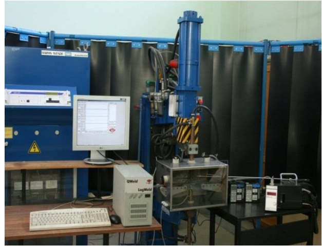
Fot.2. Stanowisko doświadczalne do badania emisji pyłu i gazów przy zgrzewaniu rezystancyjnym punktowym
