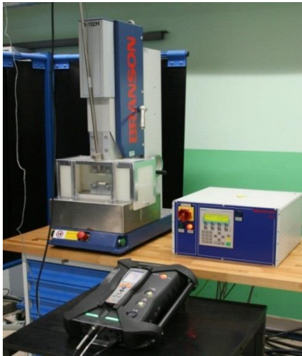
Fot.3. Stanowisko doświadczalne do badań emisji gazów przy zgrzewaniu wibracyjnym tworzyw termoplastycznych
