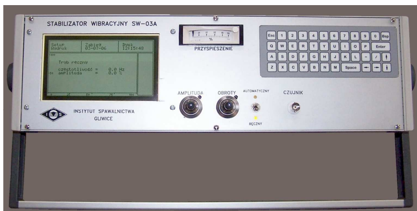
Rys. 1. Widok pulpitu sterowniczego stabilizatora wibracyjnego SW-03A od frontu
