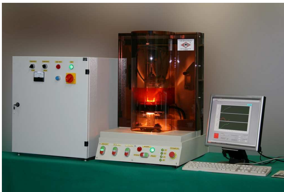
Rys. 1 Widok stanowiska badawczego do badania przemian strukturalnych w stalach
