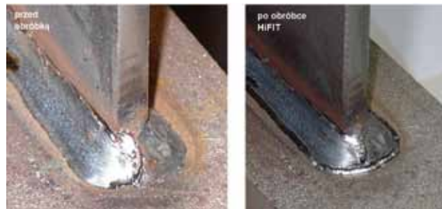
Widok złącza przed i po obróbce HiFIT (fot.: www.hifit.de)
