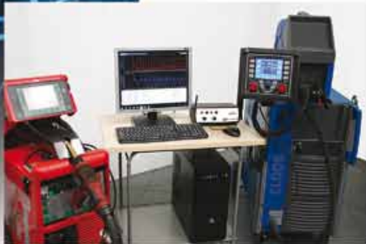
Pierwszy system do kontroli parametrów spawania w warunkach produkcyjnych, wykorzystujący sieci bezprzewodowe do komunikacji z modułami pomiarowymi
