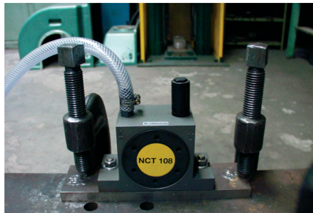
Rys. 5. Wibrator pneumatyczny turbinowy typu NCT 108
