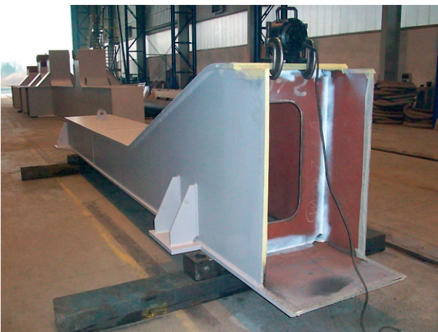
Rys. 7. Belka nośna maszyny hutniczej
