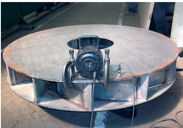
Rys. 12. Wirnik wentylatora przemysłowego w wersji masywnej (stabilizacja przy pomocy motowibratora elektrycznego)
