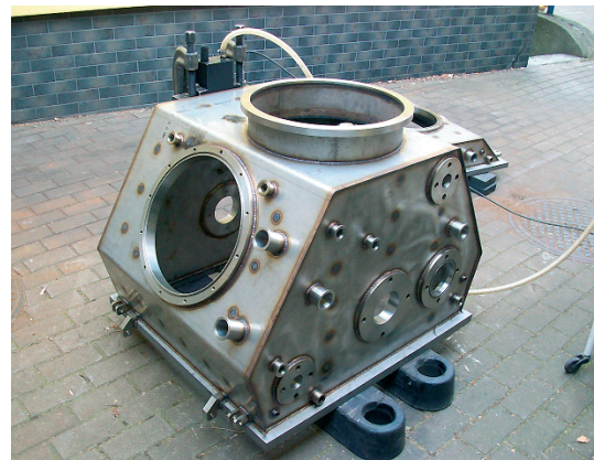
Rys. 14. Komora próżniowa (stabilizacja przy pomocy wibratora pneumatycznego)
