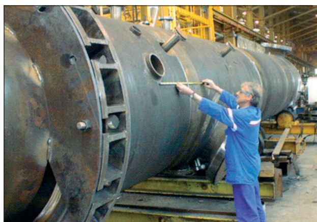
Odbiór wielkogabarytowego reaktora chemicznego w Zakładach Agriandre w okolicy Rouen
