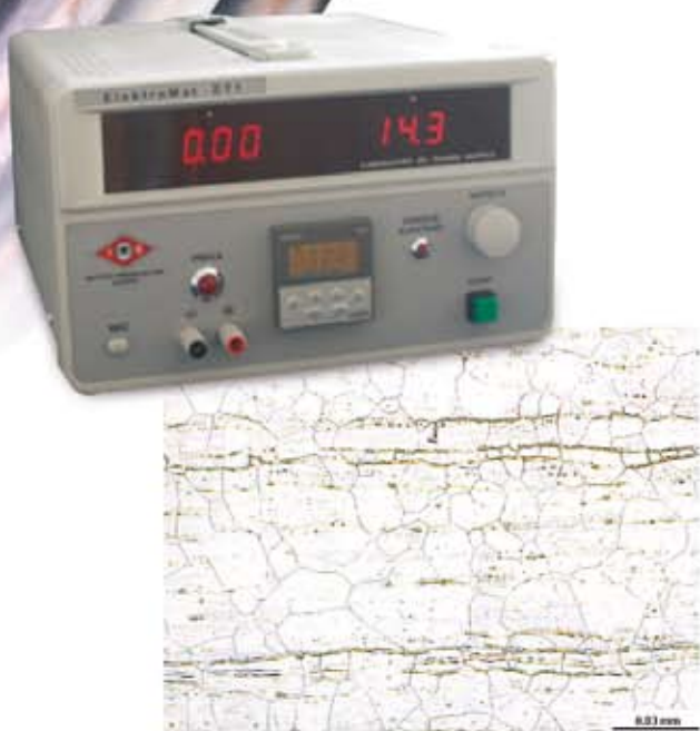
Stal wysokostopowa, austenit + ferryt delta pow. × 500 Trawienie: elektrolit EL 1
