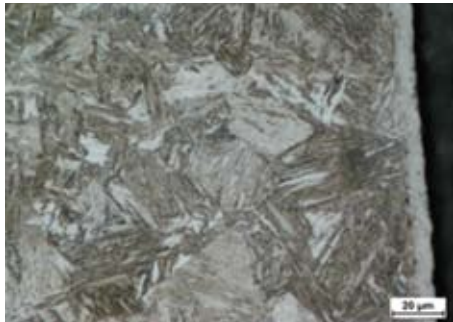
Mikrostruktura strefy wpływu ciepła obszaru cięcia plazmą pod lustrem wody, v_c = 1,6 m/min. Mikrostruktura martenzytyczno-bainityczna, trawienie odczynnikami Nitala
