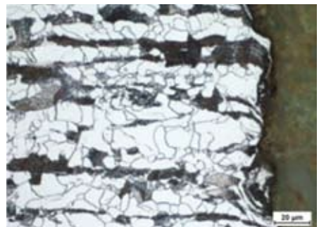
Mikrostruktura obszaru po cięciu strumieniem wody, v_c = 0,16 m/min. Mikrostruktura ferrytyczno-perlityczna, trawienie odczynnikami Nitala
